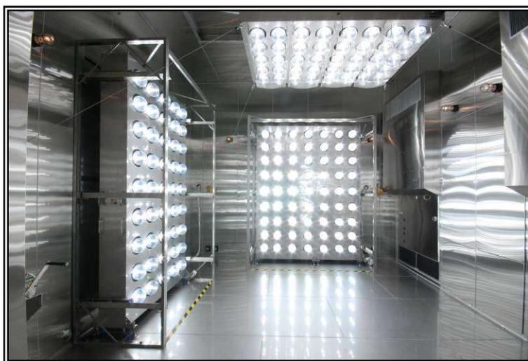
写真.1 日射試験装置
