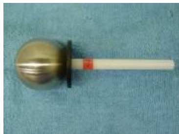
IP1X 鋼球(φ 50mm)
