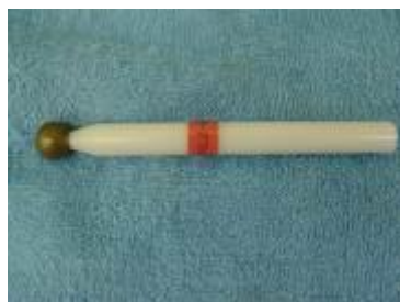
IP2X 鋼球(φ 12.5mm)
