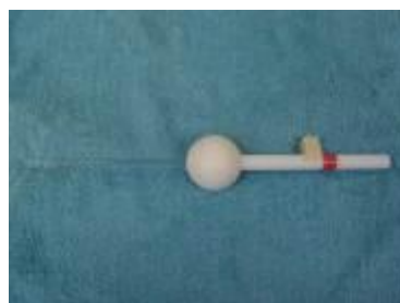
IP4X プローブ(φ 1.0mm)
