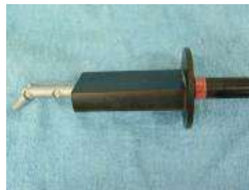
IP2X 関節付き試験指 (φ 12mm)
