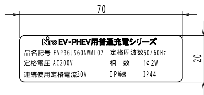
定格銘板詳細図 (1:1) (カバー裏面貼付)
