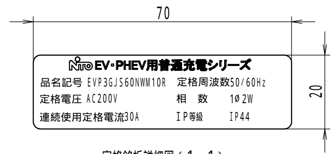
定格銘板詳細図 (1:1) (カバー裏面貼付)
