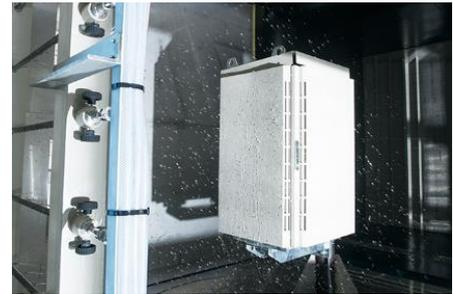
風雨性能評価試験例
