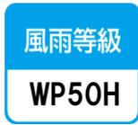
風の強さに対する保護等級が 50 (風速 50m/s) で、噴霧水量に対する保護等級が H (6L/m<sup>2</sup>・min、360 mm/h) を表しています。
