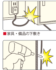
■施工時のケーブル損傷
