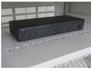
タブレット収納棚の上部に機器収納棚を配置しており、充電用 USB ポートハブやアクセスポイントなどの収納が可能です。
