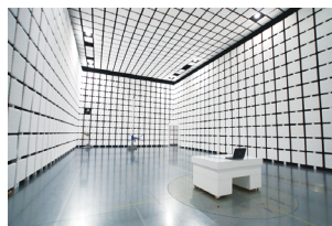
10m法電波暗室
