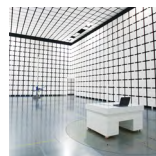
10m法電波暗室
