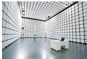
10m法電波暗室
