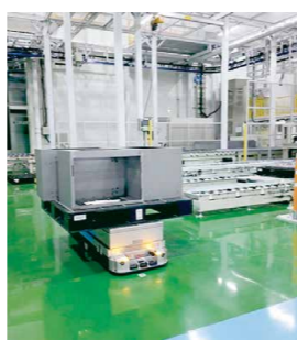
自律走行搬送ロボット(AMR)。人や障害物を避けて、自らが走行ルートを決める。
