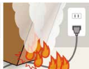
電源コードの被覆が破れて短絡(ショート)により発火
