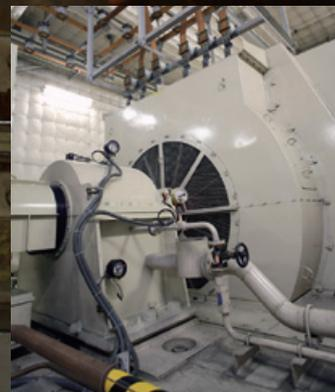
●短絡試験用発電設備
