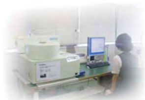
蛍光X線分析装置で有害物質の分析(一部)を実施しています。
