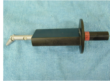
IP2X 関節付き試験指 (φ12mm)
