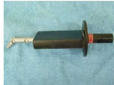
IP2X 関節付き試験指 (φ 12mm)
