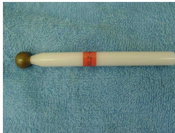
IP2X 鋼球 (φ 12.5mm)
