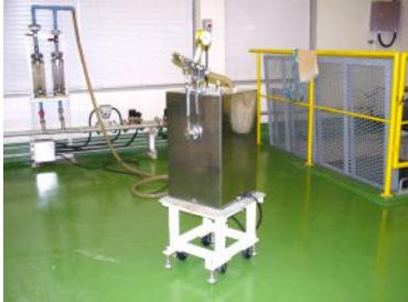
IPX5・X6 用暴噴流試験装置
