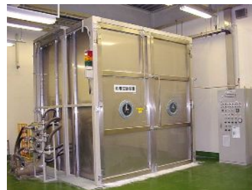
大型防塵試験装置
