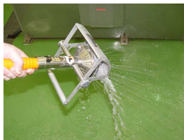
散水ノズル(X3: 10 ㍓/min)
