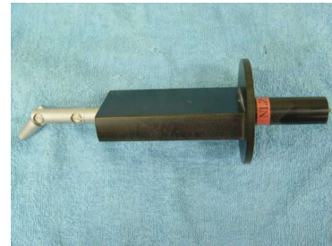
IP2X 関節付き試験指 (φ 12mm)
