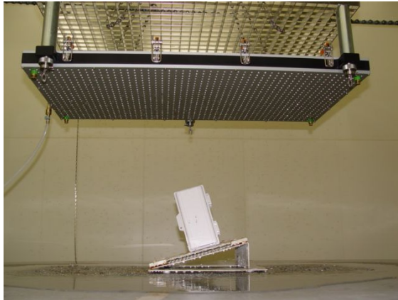
IPX1・X2 用滴水試験装置 (X1: 1mm/min、X2: 3mm/min)
