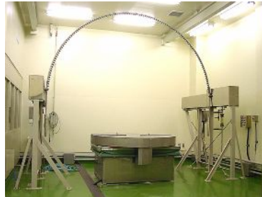
大型防水試験装置(規格外)
