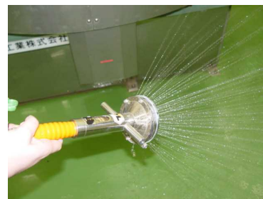
散水ノズル(X4: 10 ㍓/min)
