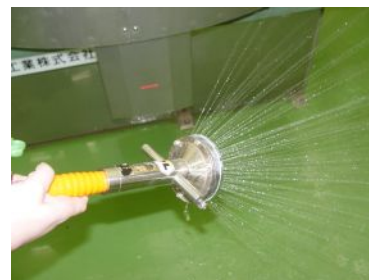
散水ノズル(X4: 10 ㍓/min)
