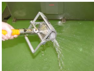
散水ノズル(X3: 10 ㍓/min)
