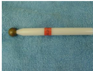
IP2X 鋼球 (φ 12.5mm)
