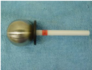
IP1X 鋼球 (φ 50mm)
