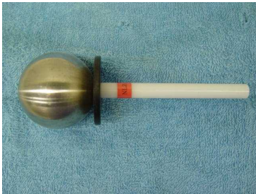
IP1X 鋼球 (φ 50mm)
