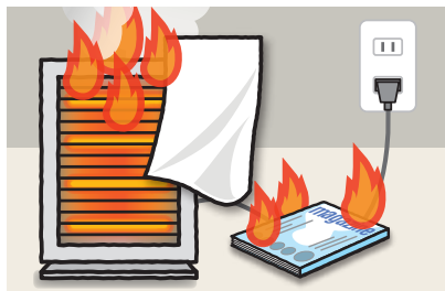
復電後、電気製品に落下した可燃物から発火
